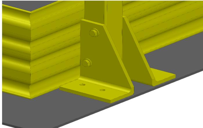
**Parafuso Sextavado M6x70mm** – Parafuso de Montagem do Guarda Corpo, fixação dos perfis no Montante, pode ser em Aço inox 316, 304.
